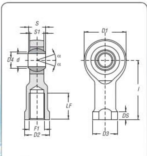
**PFI...U****TERMINALI A SNODO - BALL JOINT ENDS****VERSIONE STANDARD**
